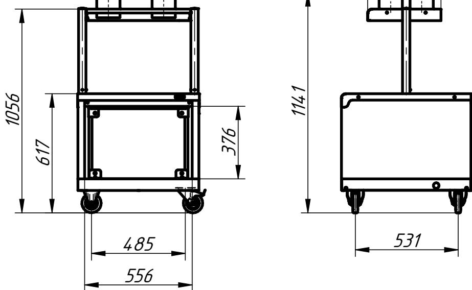
Прилавок столовых приборов и подносов предназначен для раздачи потребителям столовых приборов и подносов в составе линии раздачи. Прилавок имеет четыре пластиковые емкости для вилок, ложек и ножей. На ваш выбор имеется большое количество вариантов быстросъёмных фасадов. Прилавок имеет регулируемые по высоте ножки. С лицевой стороны ножки закрываются фартуком.
